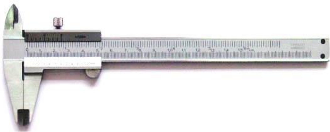
ภาพที่ 2.1 เวอร์เนียร์คาลิปเปอร์แบบทั่วไป
