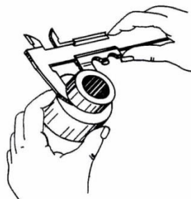
ภาพที่ 2.4 วิธีใช้ปลายปากวัดนอกวัดความโตนอกที่มีลักษณะทรงกระบอก ๆ
